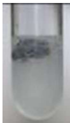
Fig.V.7. Formarea staniului metalic
