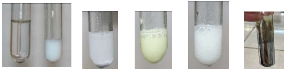
Fig.V.1. Precipitate ale ionului \text{Ag}^+ : a. \text{AgCl} ; b. \text{AgBr} ; c. \text{AgI} ; d. \text{Ag}_2\text{CO}_3 ; e. Oglinda de argint
