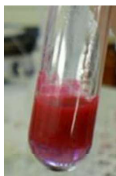
Fig.V.14. Complexul ionului de nichel cu DMG
