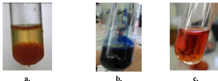
Fig. V.10. Precipitate, respectiv complecși ai ionului \text{Fe}^{2+} : a. \text{Fe}(\text{OH})_2 ; b. \text{Fe}_3[\text{Fe}(\text{CN})_6]_2 ; c. Chelatul cu 2-2'-Dipiridil
